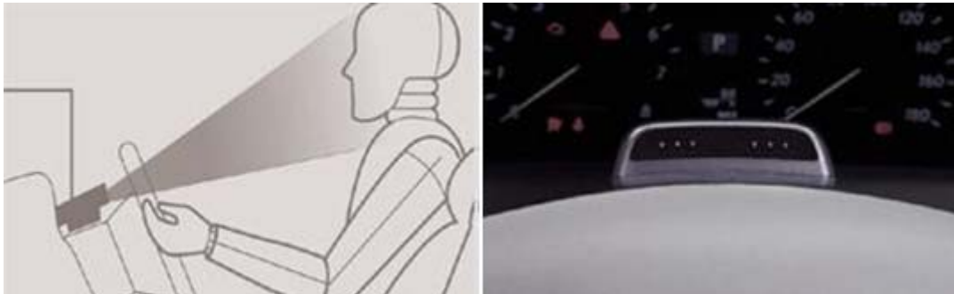
Abbildung 19: Anordnung der Fahrerbeobachtungskamera beim Lexus Pre-Crash Safety System 34
